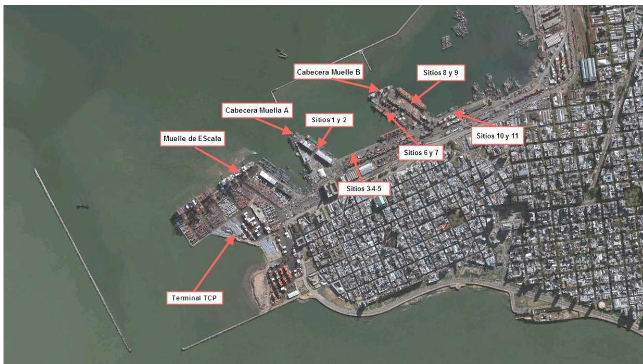
La Terminal TCP se desarrolla, según se aprecia en la Figura 7.3, en el sector del puerto más próximo a la boca de entrada. Cuenta actualmente con una superficie de 33 hectáreas (27 de las cuales están pavimentadas) y un frente de atraque de 638 metros de longitud. Este frente es la consecuencia de la ampliación (en una extensión de 350 metros hacia el Oeste) realizada al histórico Muelle de Escala (de 288 metros).
